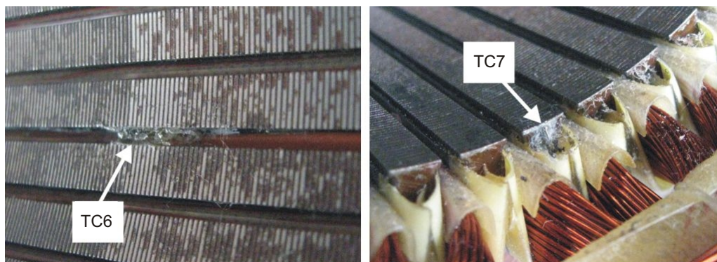
Obr. 5.4: VLEVO: UMÍSTĚNÍ TERMOČLÁNKU TC6 VE STATOROVÉ DRÁŽCE (VE STŘEDU DÉLKY PAKETU). VPRAVO: UMÍSTĚNÍ TERMOČLÁNKU TC7 NA ČELE ZUBU (NA STRANĚ VENTILÁTORU STROJE).
