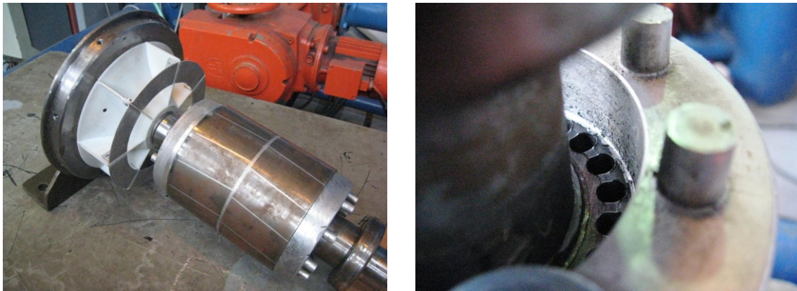
Obr. 5.16: ROTOR OSAZENÝ UPRAVENÝM VENTILÁTOREM A ČELNÍM ŠTÍTEM (VLEVO). KRUHOVÉ AXIÁLNÍ KANÁLY V ROTORU (VPRAVO).
