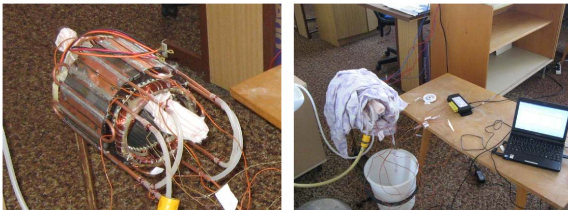
Obr. 5.40: STATOR S PROPOJENÝM VODNÍM OKRUHEM UMÍSTĚNÝ NA IZOLOVANÉM STOJANU (VLEVO). MĚŘÍCÍ PRACOVNÍSTĚ S TEPELNĚ IZOLOVANÝM STATOREM (VPRAVO).
