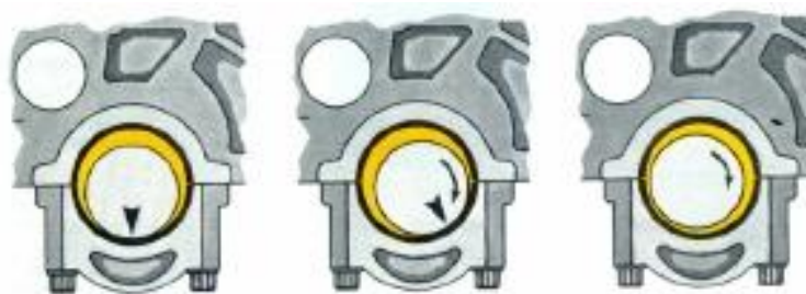
Obr. 3.5 Vznik hydrodynamického mazání kluzného ložiska [2],
