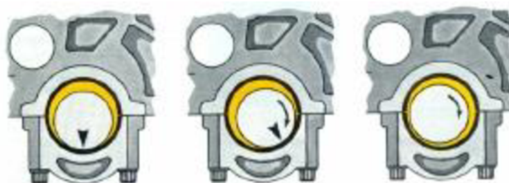
Obr. 3.5 Vznik hydrodynamického mazání kluzného ložiska [2],
