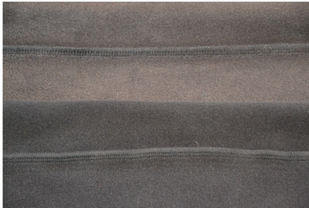
Obr. 16: Obnitkovací 4nitný steh řetízkový a hřbetový šev (sežehlený) s PES nitěmi
