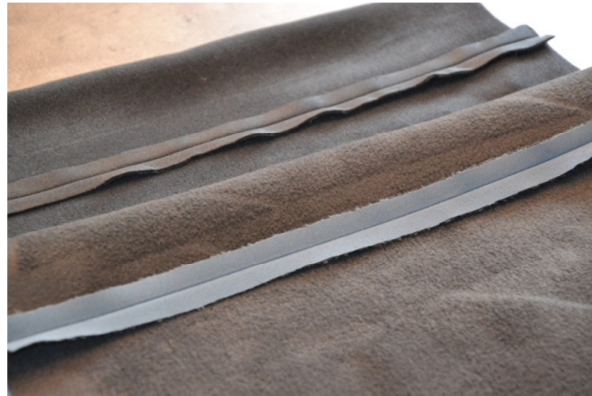
Obr. 17: Vázaný steh 1nitný a hřbetový šev (rozžehlený)
