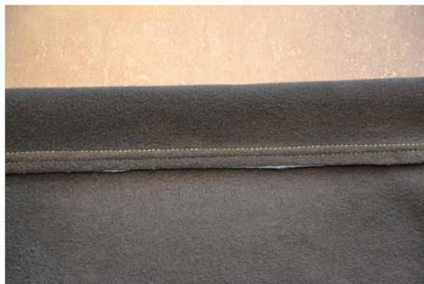
Obr. 19: Přeplátovaný zahnutý šev a vázaný steh 1nitný s PAD nitěmi
