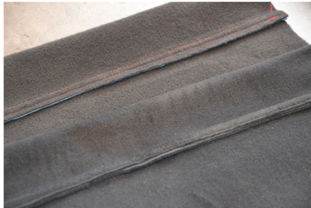
Obr. 18: Přeplátovaný zahnutý šev a vázaný steh 1nitný s PES nitěmi
