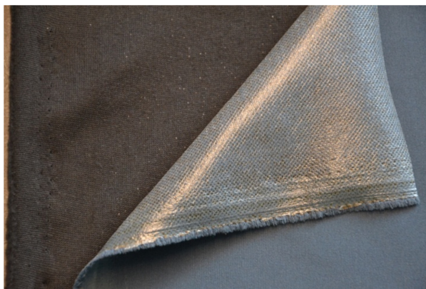
Obr. 11: Ukázka jednotlivých vrstev materiálu softshell
