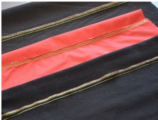
Obr. 14: Obnitkovací 5nitný steh řetízkový a hřbetový šev s PAD nitěmi
