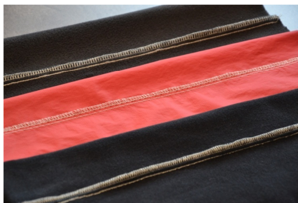
Obr. 13: Obnitkovací 5nitný steh řetízkový a hřbetový šev s PES nitěmi
