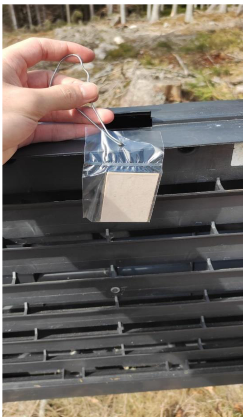
Obrázek č. 10: Uchycení feromonových odparníků v nárazovém lapači
