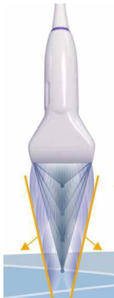
Obrázek 3 - Generování pomocí SonicTouch™. Příčné vlny jsou zesíleny ve tvaru "Machova kuželu"
