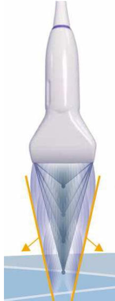
Příloha 3 - Generování pomocí SonicTouch™. Příčné vlny jsou zesíleny ve tvaru "Machova kuželu"
