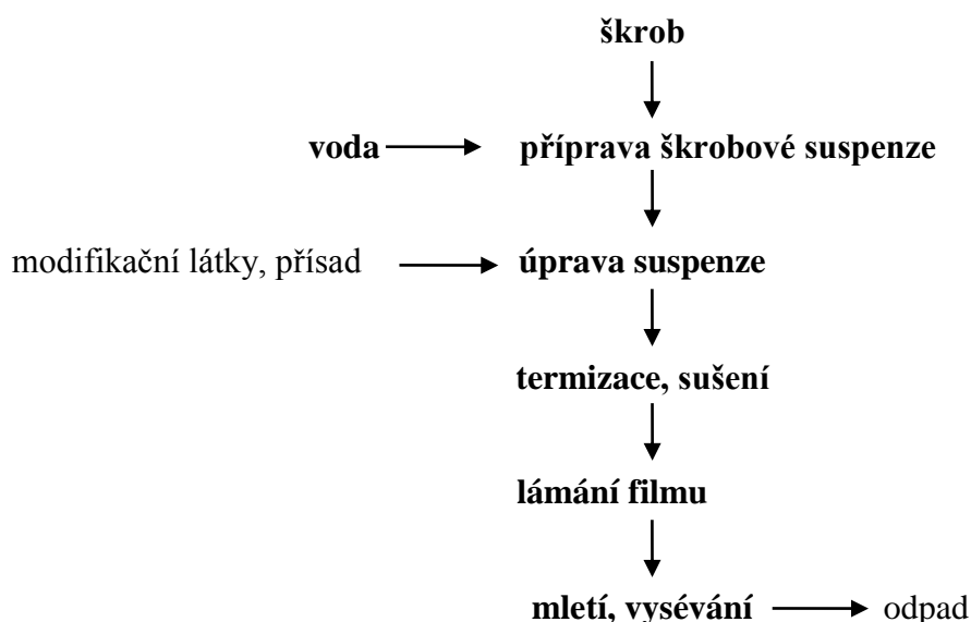
Obr. 9: Schéma termické modifikace na sušícím válci (Kodet a Babor, 1991)
