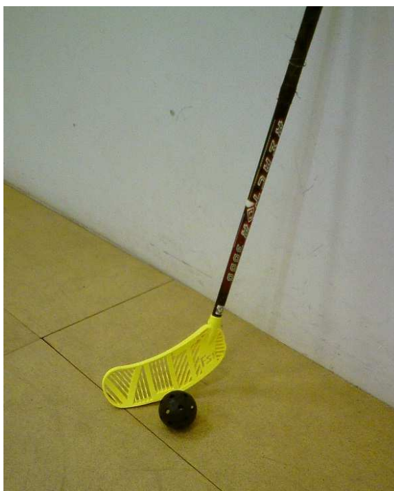
Obr. 5.3 Prototyp čepele nasazený a přišroubovaný k florbalové holi.
