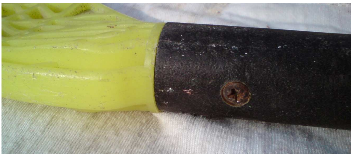
Obr. 1.3 Původní způsob uložení čepel a hole.
