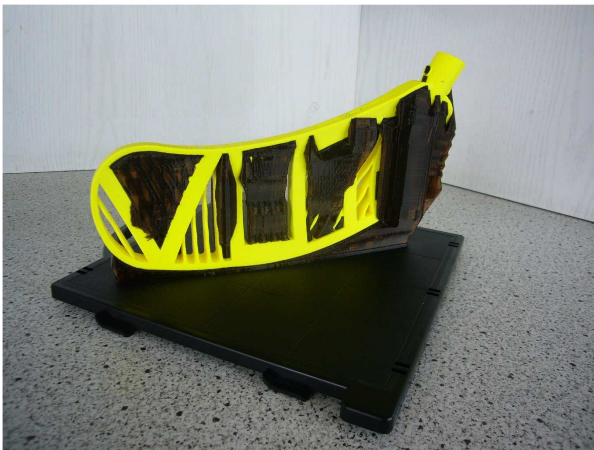
Obr. 4.6 Model čepele florbalové hole po vyjmutí z tiskárny uPrint.
