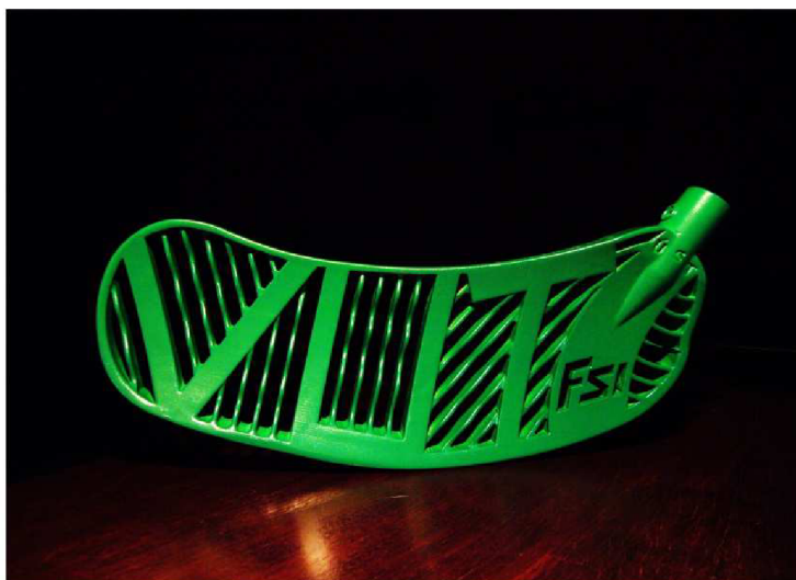
Obr. 4.9 Finální úprava a vzhled: a) použitý sprej Dupli-Color Prima RAL, b) konečná podoba čepce florbalové hole.
