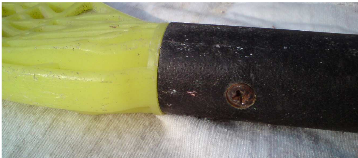
Obr. 1.3 Původní způsob uložení čepele a hole.
