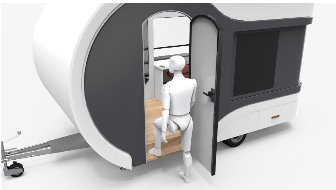
Obr. 6-11 Schodek vyrovnávající výškový rozdíl
