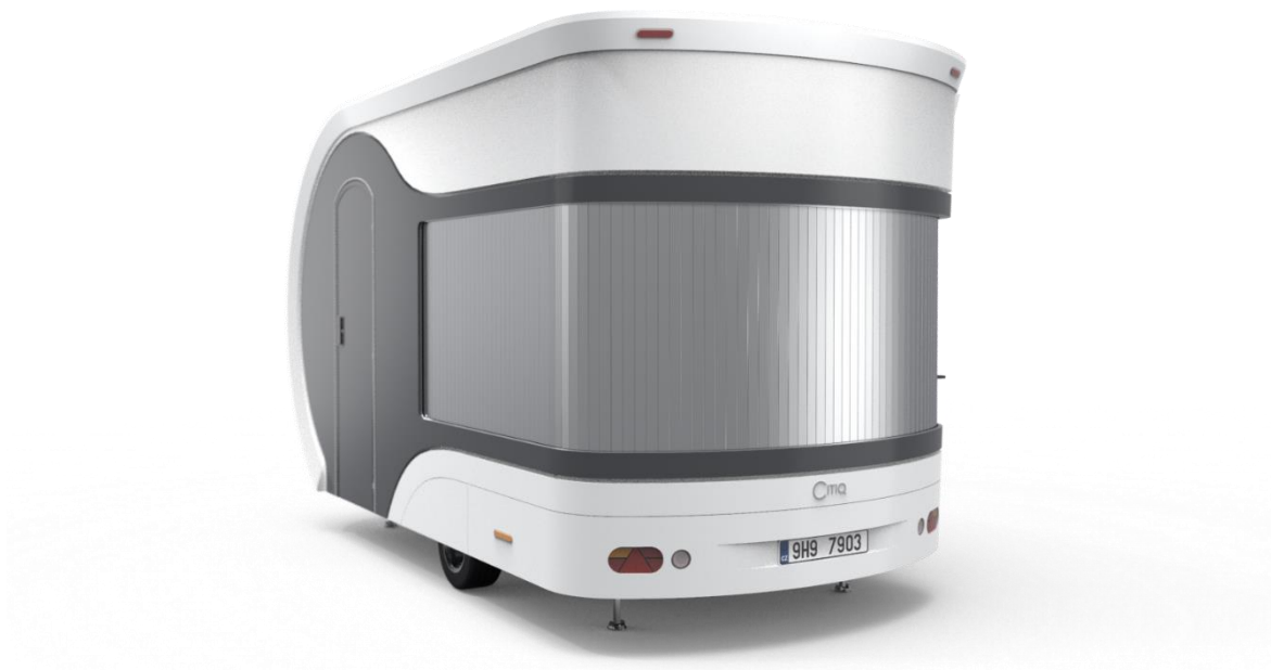
Obr. 6-18 Krytí displejů zatahovací kovovou roletou
