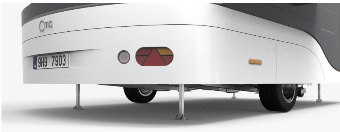
Obr. 6-7 Stabilizační výklopné podpěry
