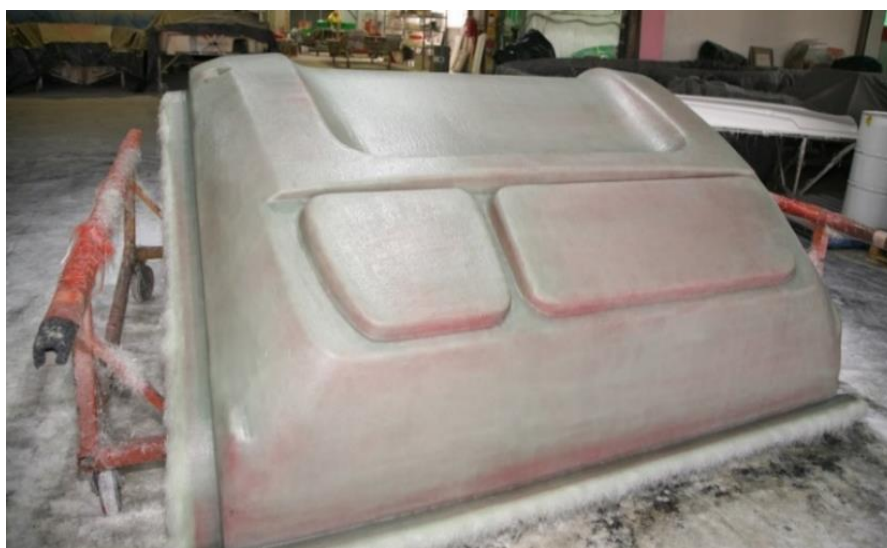
Obr. 2-21 Část karoserie karavanu ze vstřikovaného sklolaminátu [32]
