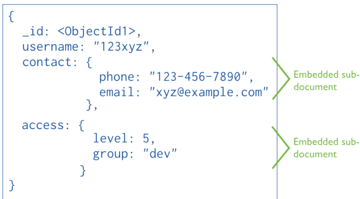
Obrázek 5.2: Diagram představující přístup vnořených dokumentů. Zdroj: [12]
