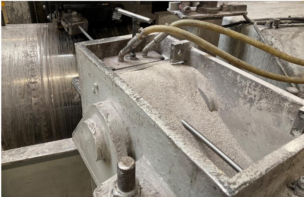
Obr. 35 Drát procházející zásobníkem s práškem a průvlakem
