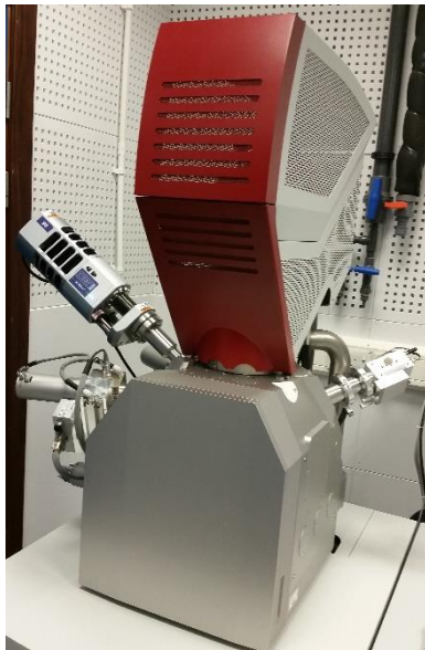
Obr. 27 Rastrovací elektronový mikroskop MIRA3 firmy TESCAN [69]
