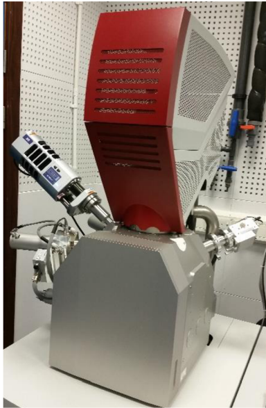
Obr. 27 Rastrovací elektronový mikroskop MIRA3 firmy TESCAN [69]
