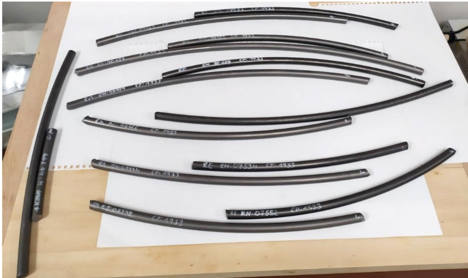
Obr. 46 Vzorky drátu odebrané po tažení
