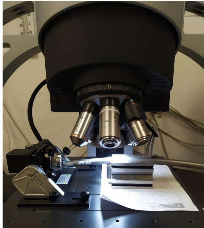
Obr. 50 Snímání vzorků pomocí přístroje Alicona InfiniteFocus G5
