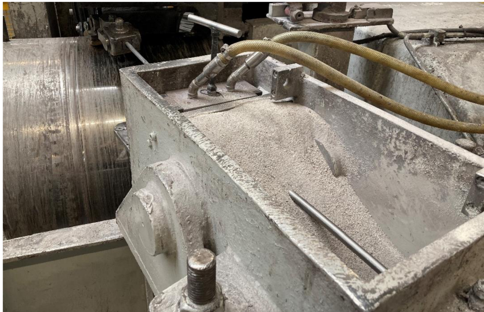
Obr. 35 Drát procházející zásobníkem s práškem a průvlakem
