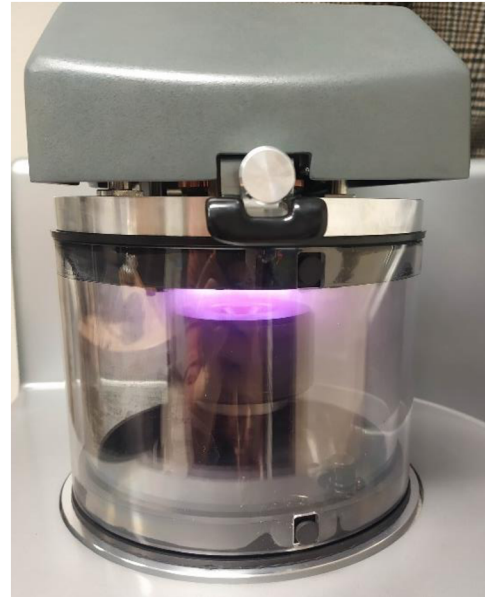
Obr. 28 Pokovení nástroje v naprašovačce
