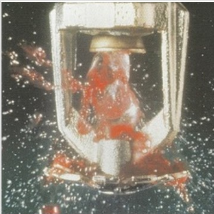
Obr. 4.3 Prasknutí skleněné pojistky splinkerovy hlavice a otevření uzávěru vody Zdroj: [16].
