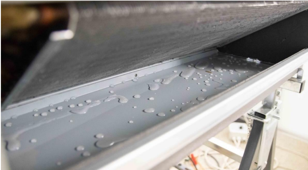
Obrázek 41: Usazování a odtok kondenzátu v kondenzační vane
