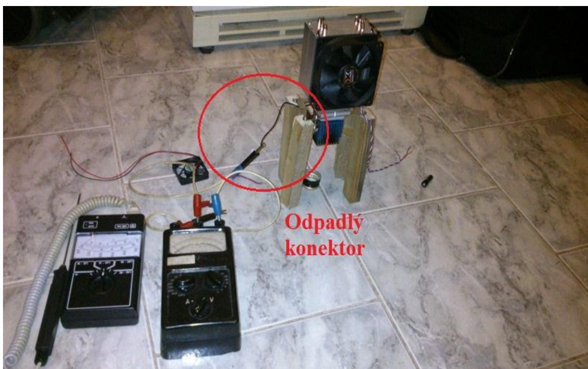
Obr. 21 Konstrukce s odpadlým konektorem
