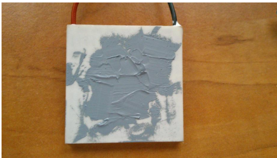
Obr. 23 Peltierův článek s nanesenou vrstvou pasty Xigmatek
