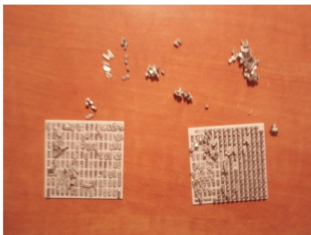
Obr. 9 Rozpadlý peltierův článek
