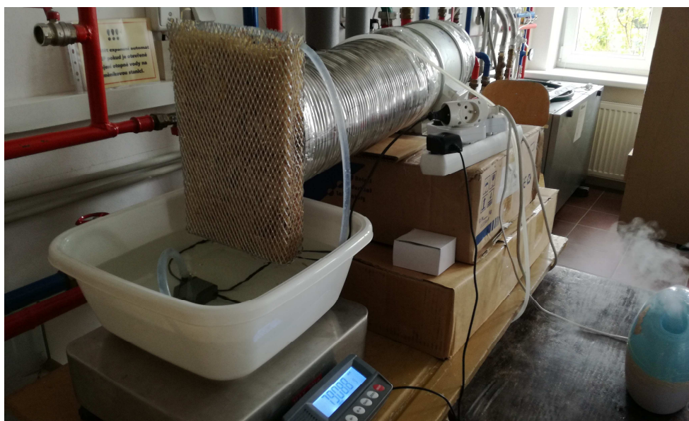
Obrázek C.29 Zkrápěný zvlhčovač, vpravo pak ultrazvukový zvlhčovač
