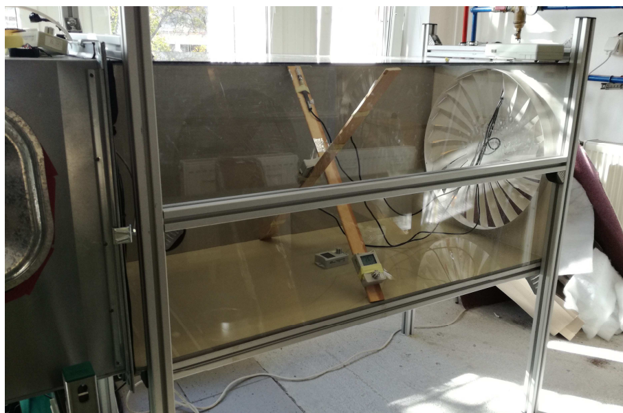
Obrázek C.26 Prodloužený kus s čidly na straně výfuku ventilátoru
