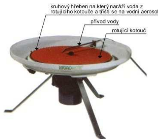
Obrázek A.2 Mechanický kotoučový zvlhčovač [2]
