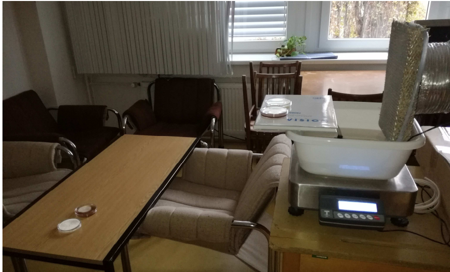
Obrázek C.30 Rozmístění Petriho misek za zkrápěným adiabatickým chladičem
