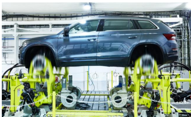
Obr. 44 Zkouška dynamického zatížení modelu Kodiaq na hydropulzním zařízení [3]
