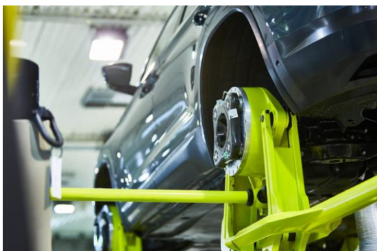
Obr. 43 Uchycení modelu Kodiaq na hydropulzním zařízení [3]
