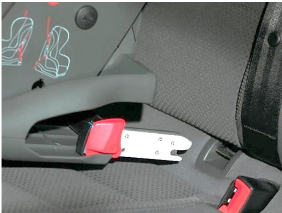
Obr. 7 Umístění bezpečnostního systému ISOFIX na sedadle [5]
