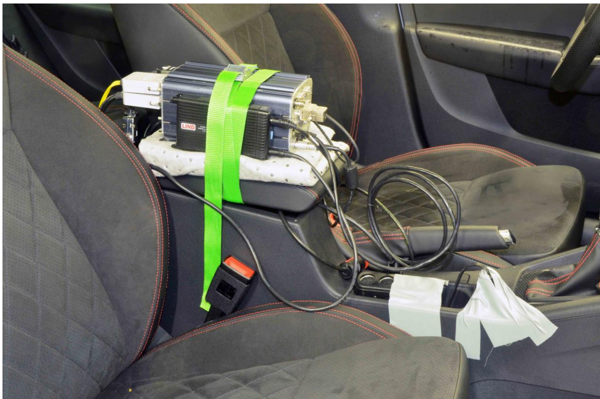
Obr. 2 Současné použití uchycení IMC aparatury v interiéru vozu Škoda Octavia RS
