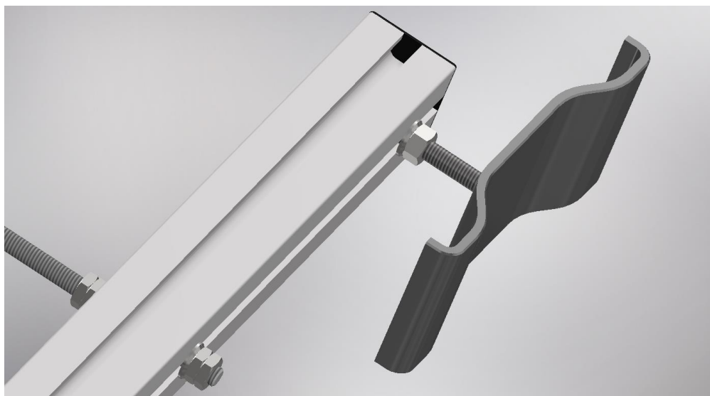
Obr. 36 Detail přitlačné části horního rozpěrného mechanismu
