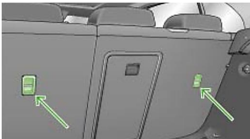
Obr. 11 Uchycovací bod Top Tether u modelu Superb [9]
