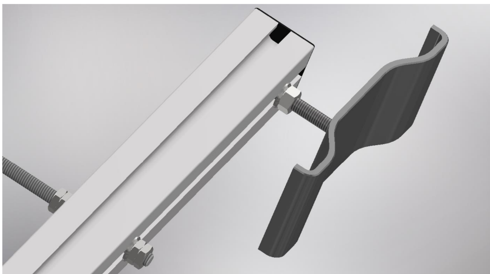
Obr. 36 Detail přitlačné části horního rozpěrného mechanismu
