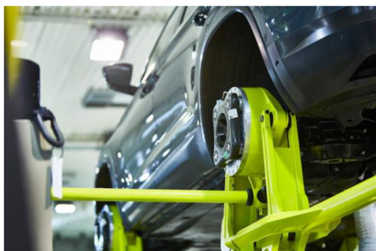
Obr. 43 Uchycení modelu Kodiaq na hydropulzním zařízení [3]
