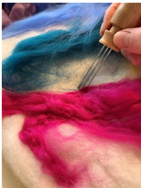
Obr. 9 Ukázka suchého plstění za použití třech plstících jehel při podložení molitanem
