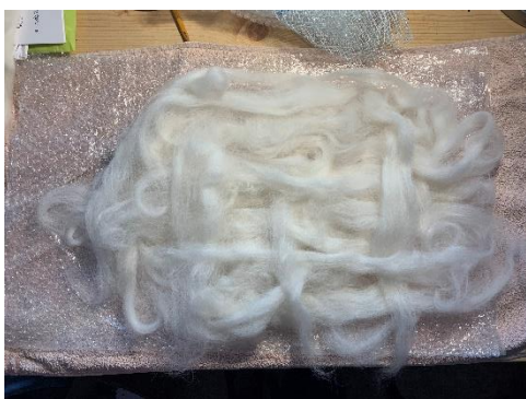
Obr. 35 Kladení čistého rouna pro následné měkké plstění
