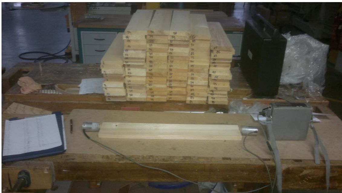
Obr. 17 Zjišťování rychlosti šíření zvuku, přístrojem Arborsonic
