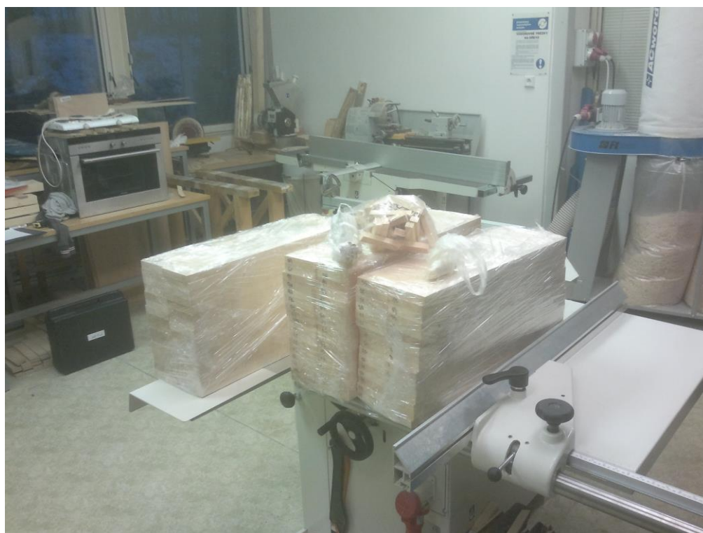
Obr. 18 Balení a převoz vlhkých prken zabalených do strečové fólie, která zamezila vlhkostním změnám
