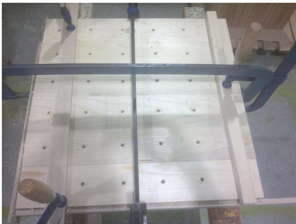
Obr. 20 Vrtání otvorů pro kolíky
