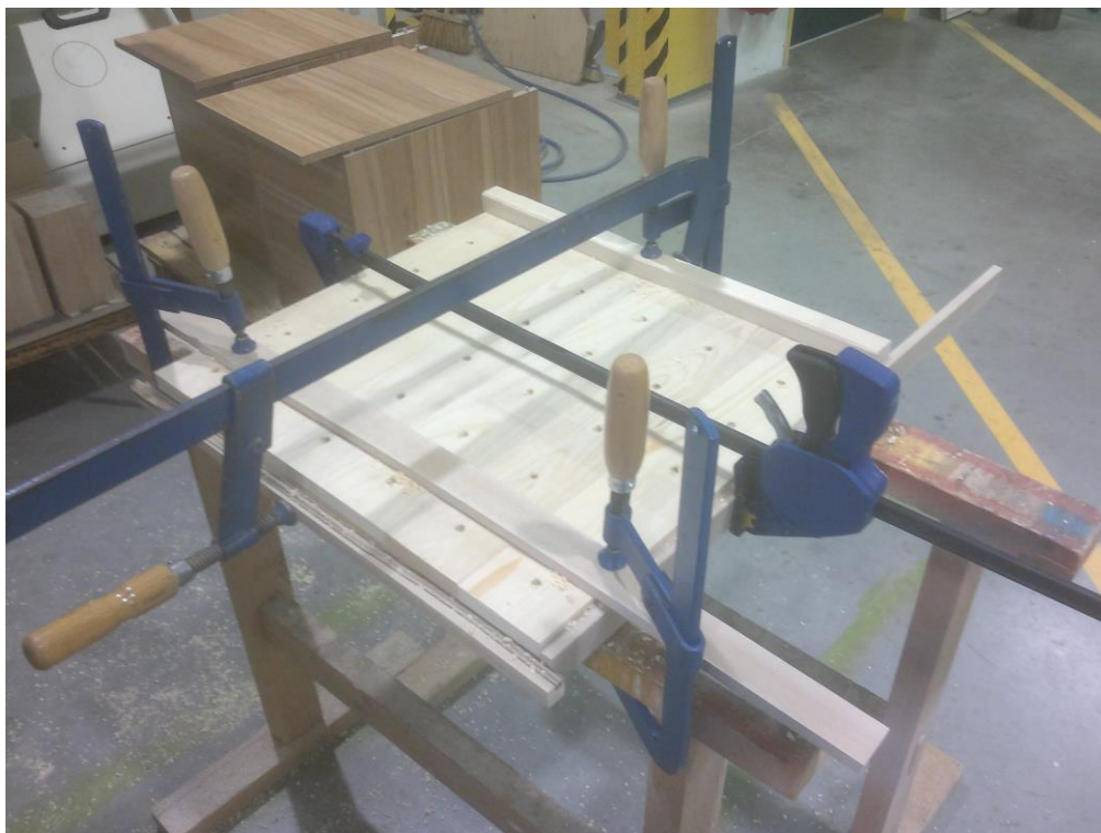
Obr. 19 Samotná výroba panelů (vrstvení prken, stáhnutí pro zajištění a vrtání otvorů pro kolíky)
