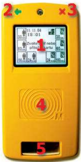
obr.5 čtečka CARDMAN užívaná v projektu Plzeňská karta [int.7]
