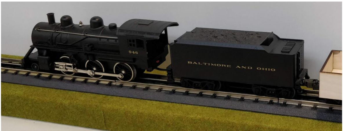
Obrázek 10: Lokomotiva s tendrem pro elektroniku na testovacím kolejišti
