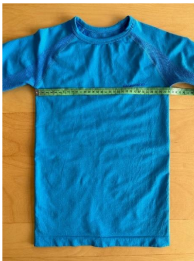
Obr. 19 Příklad měření rozměru 1/2 šíře hrudníku na výrobku.
