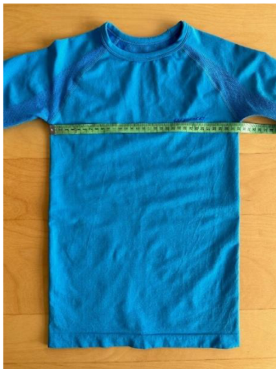
Obr. 19 Příklad měření rozměru 1/2 šíře hrudníku na výrobku.
