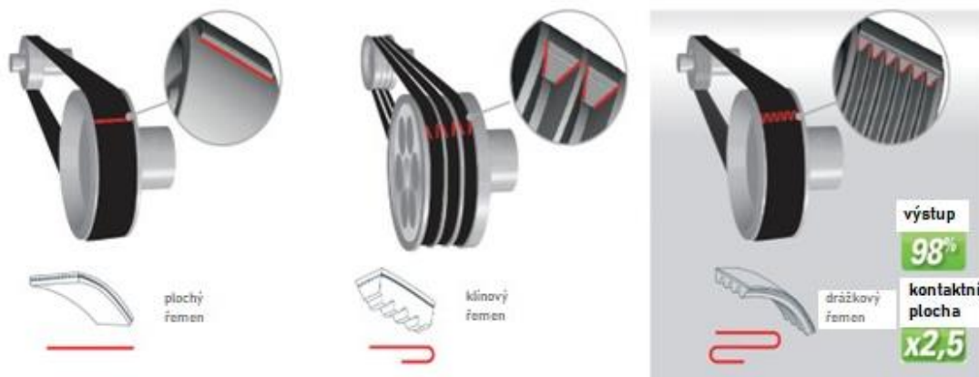
Obr. 8 Ukázka výhody větší styčné plochy u drážkového řemenu [11].
