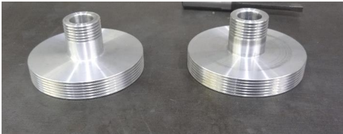
Obr. 62 Vyrobené řemenice podle CNC programu.
