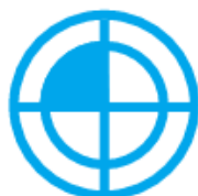
Obr. 46 Symbol nulového bodu stroje M [28].
