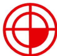
Obr. 47 Symbol nulového bodu obrobku W [28].
