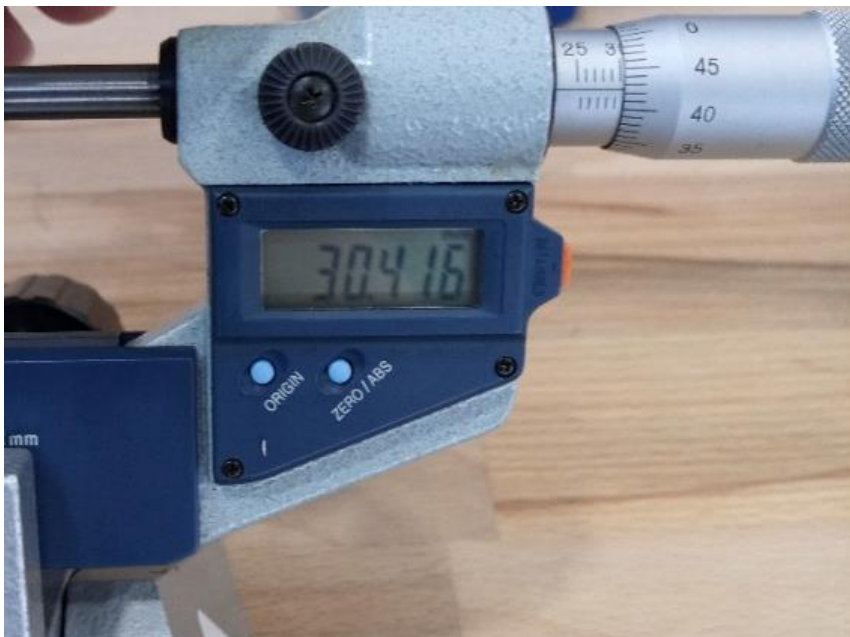
Obr. 65 Měření rozměru přes drátky na menším osazení.
