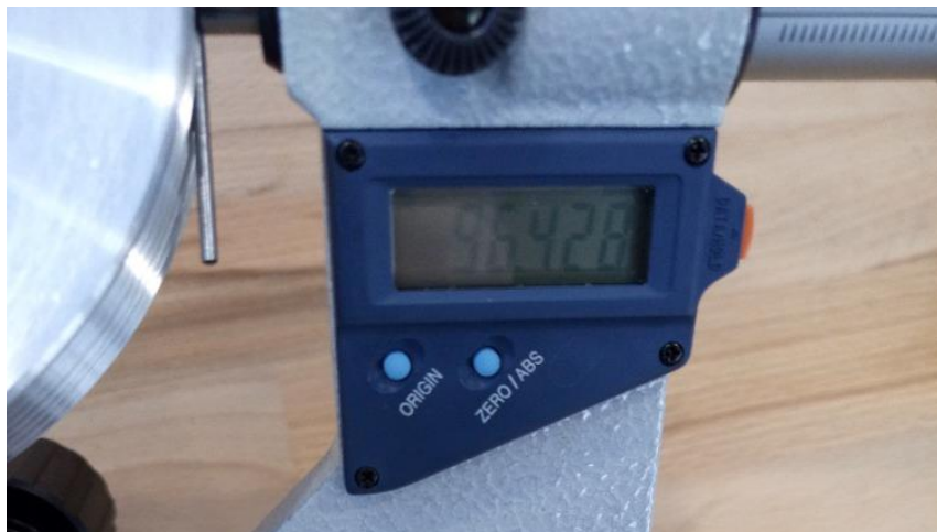
Obr. 66 Měření rozměru přes drátky na větším osazení.
