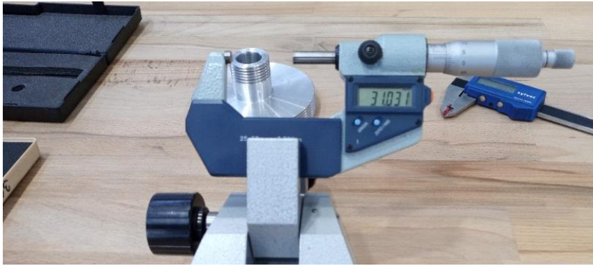
Obr. 64 Měření rozměrů přes drátky.
