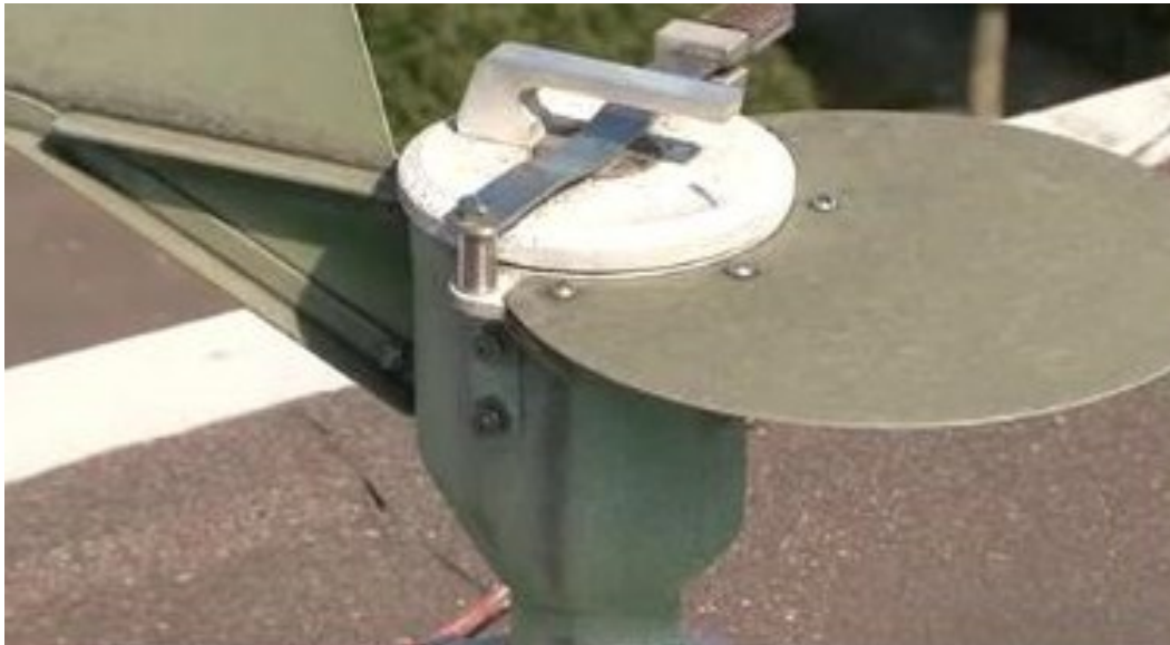
Obr. 7 Vrchní část pylového volumetrického lapače (Zdroj: pylovaslužba.cz, 2013)
