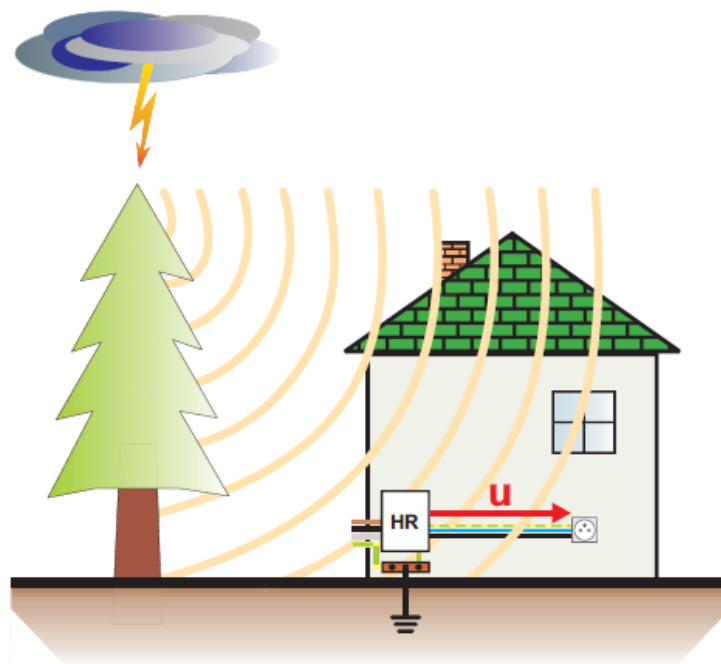
Obr. 3-3: Vzdálený (nepřímý) úder blesku; převzato z [17].
