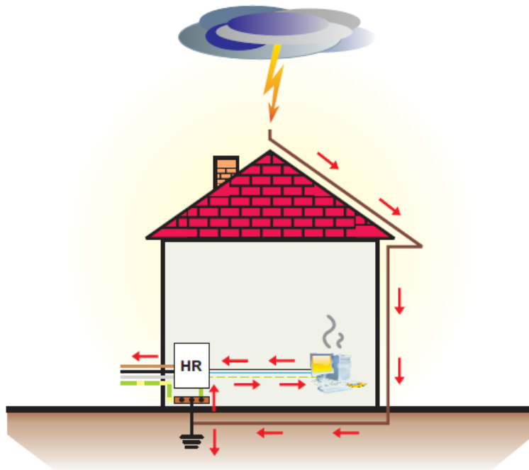
Obr. 3-1: Přímý úder blesku; převzato z [17].
