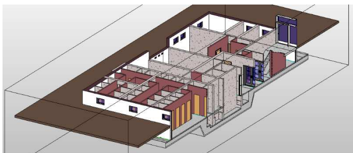
Obr. 83 Fiktivní deska znázorňující úroveň terénu v BP
