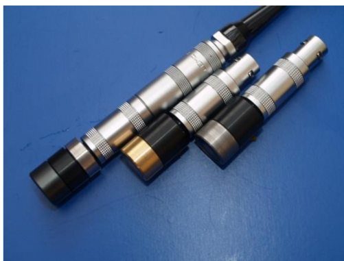
Obr. 7.29 Stínící kryty na jednotlivých sondách (ferit, mosaz, slitina železa)
