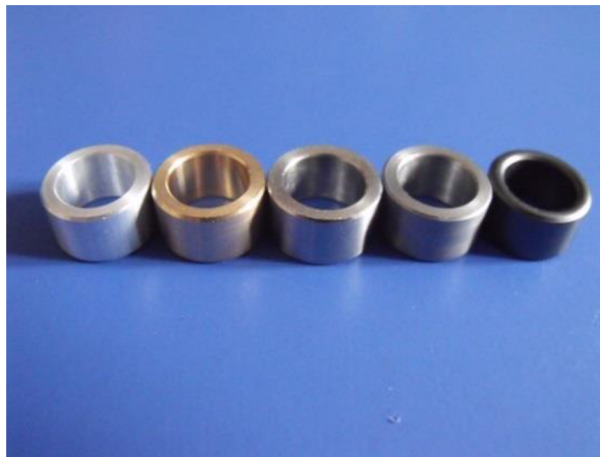
Obr. 6.1 Stínící kroužky v pořadí hliník, mosaz, austenitická ocel, slitina železa, ferit
