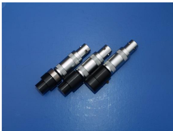
Obr. 6.2 Sondy vířivých proudů pro kontrolu kompozitních uhlíkových materiálů
