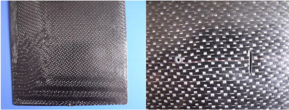
Obr. 6.3 Zvlnění a překrytí tkaniny (vlevo), vývrt a drážka (vpravo)
