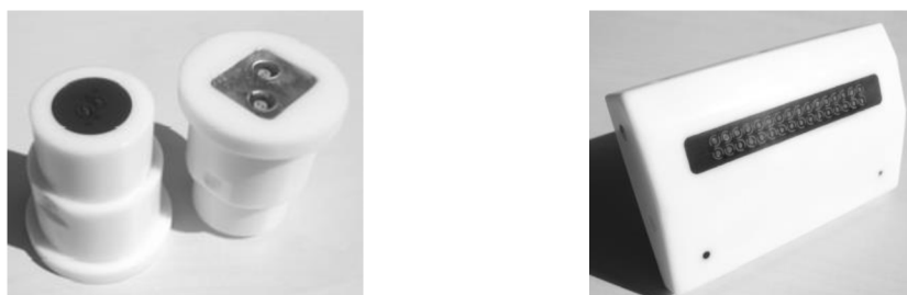
Obr. 3.24 Ukázka anizotropního senzoru (vlevo), 16 párového senzoru (vpravo) [12]
