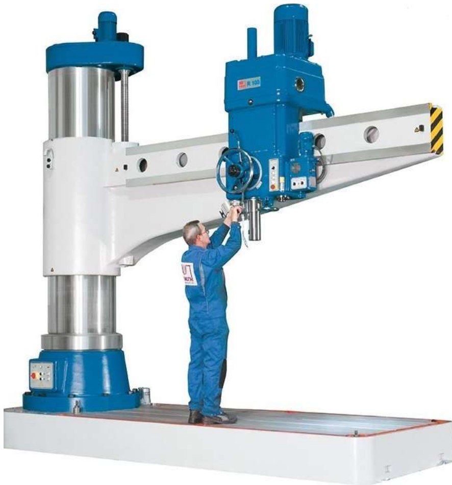
Obr. č. 10 Sloupová radiální vrtačka KNUTH R100 [20] (K základové desce je připevněn sloup, po sloupu se ve svislém směru pohybuje rameno s vřeteníkem.)
