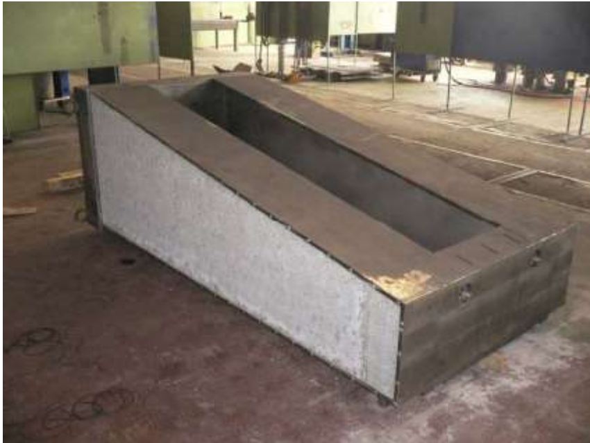
Obr. č. 22 Stojanové těleso obráběcího stroje s vlepeným blokem hliníkové pěny [26]
