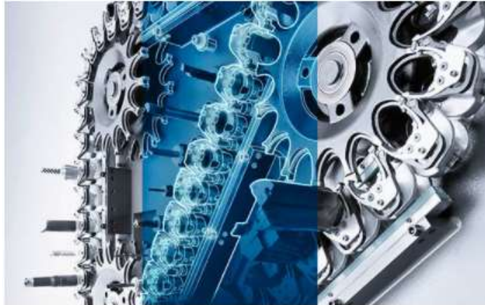
Obr. č. 53 Pásový zásobník pro 180 kusů nástrojů [35]
