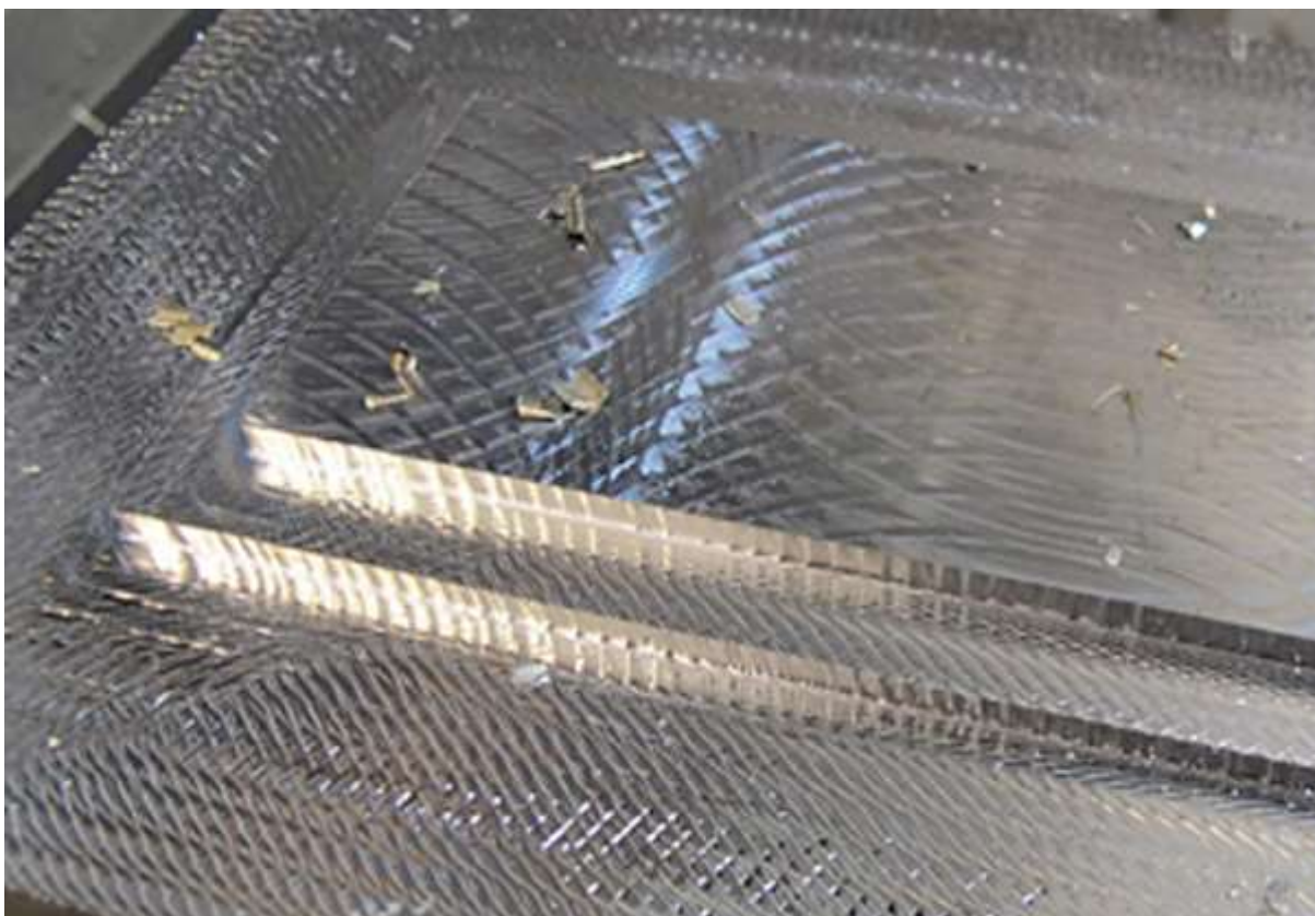
Obr. č. 31 Zvlněný povrch vzniklý v důsledku působení samobuzeného kmitání [29]
