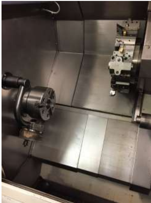
Obr. č. 39 Detail vnitřní části obráběcího stroje [30] (šikmé lože pro dostatečný odvod třísek z místa řezu)
