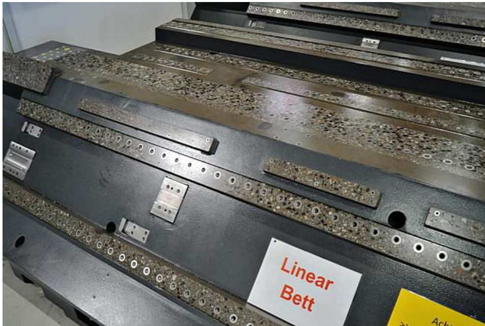
Obr. č. 20 Lože obráběcích strojů z polymerbetonu [21]
