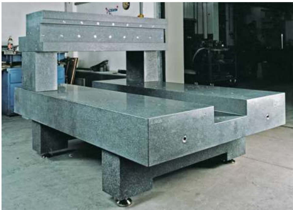
Obr. č. 21 Žulové lože (firma Oelze) [19]
