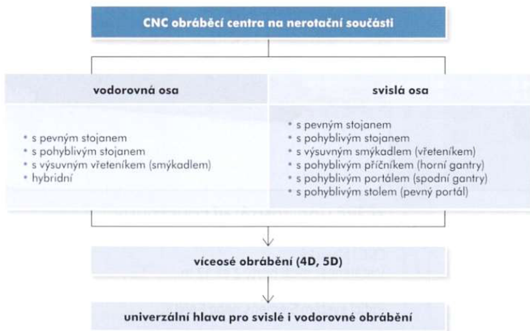
Obrázek č. 4: Rozdělení CNC obráběcích center na nerotační součásti [1]
