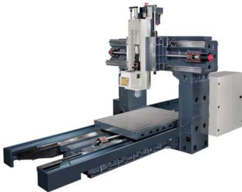
Obr. č. 13 Základní skelet strojů řady TREX [17] (Příčka uložena na dvou sloupech, vřeteno uloženo na smýkadle)
