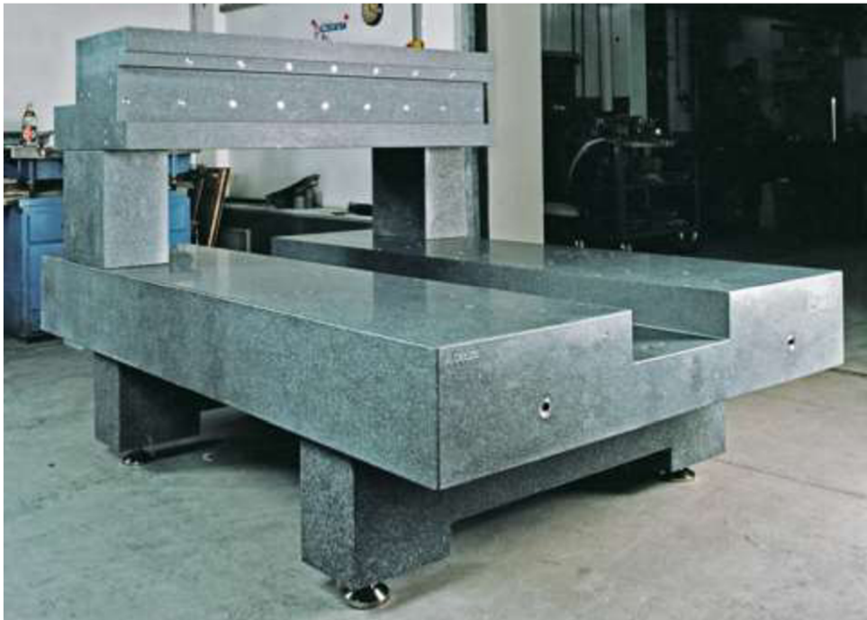
Obr. č. 21 Žulové lože (firma Oelze) [19]
