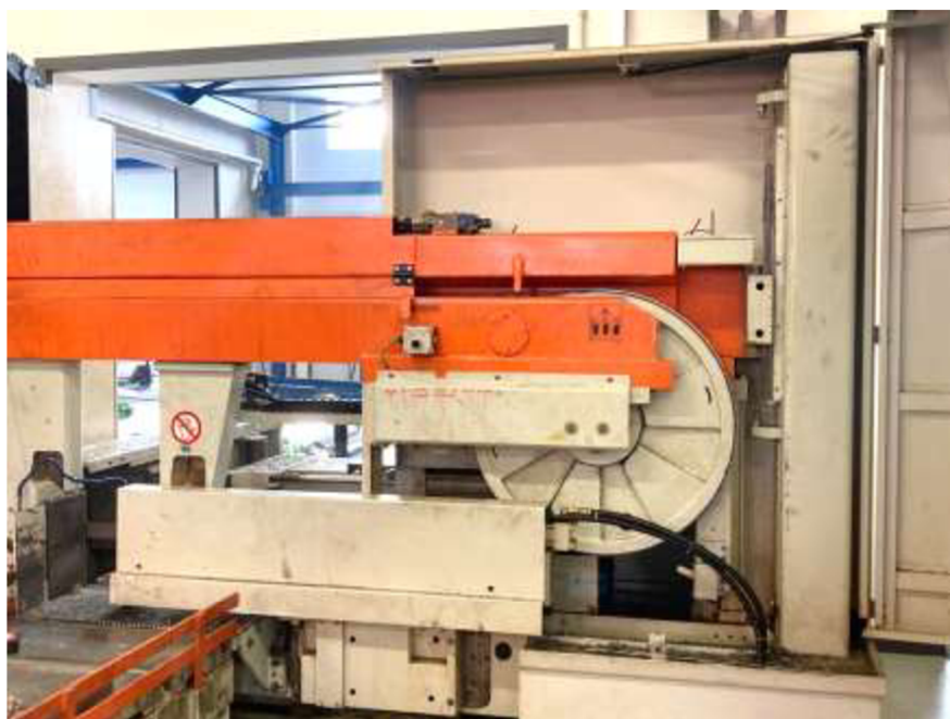
Obr. č. 12 Uložení příčníku na vedení jednoho ze dvou stojanů (Pila KASTOtec AC5)
