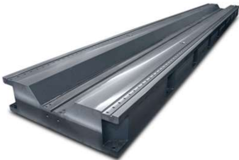
Obr. č. 19 Lože zhotovené litím (Slévárna Stolle) [18]
