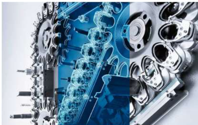
Obr. č. 53 Pásový zásobník pro 180 kusů nástrojů [35]
