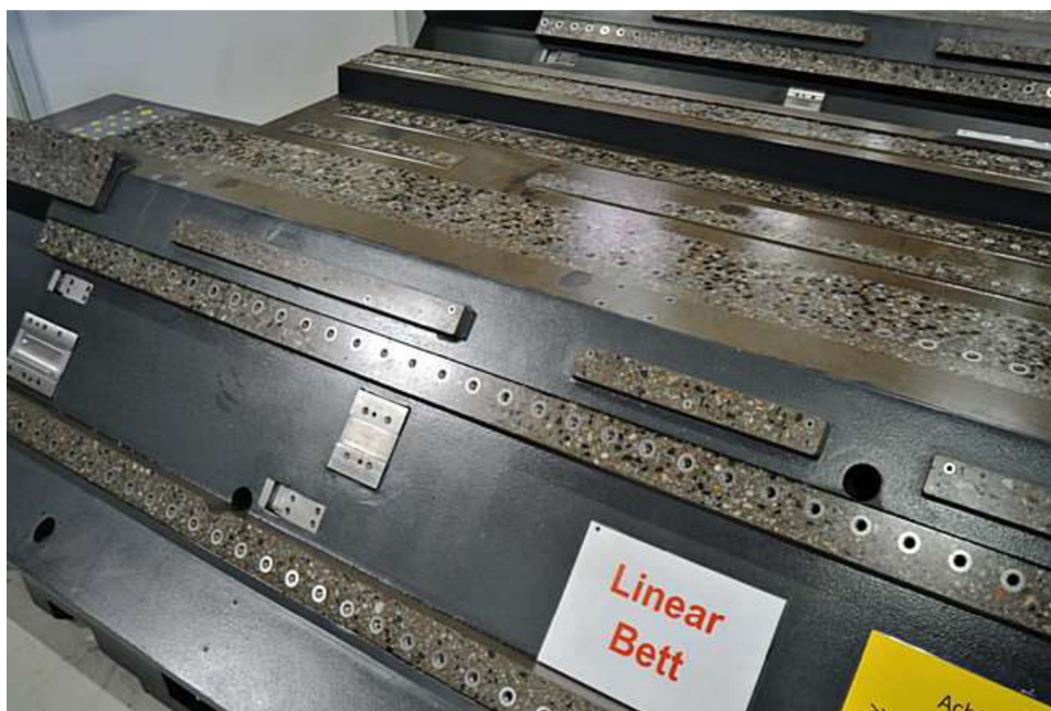
Obr. č. 20 Lože obráběcích strojů z polymerbetonu [21]
