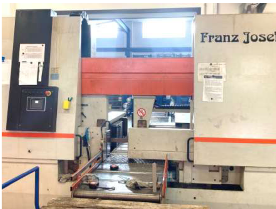
Obr. č. 11 Příčník (oranžový) uložený na dvou vodících svislých stojanech (Pila KASTOtec AC5)
