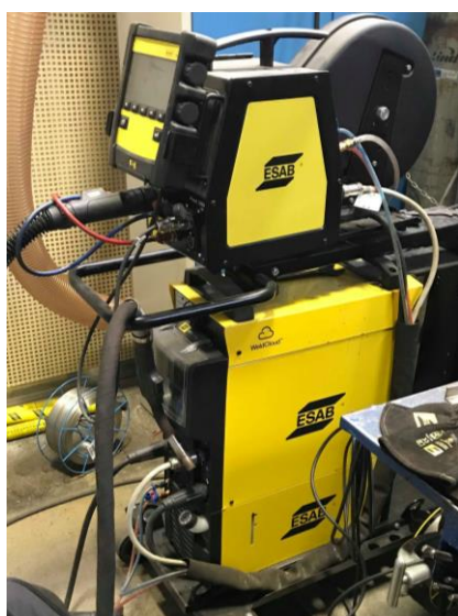
Obr. 31 a 32 Zdroj pro svařování, podavač drátu a ovládací panel Aristo U8 2
