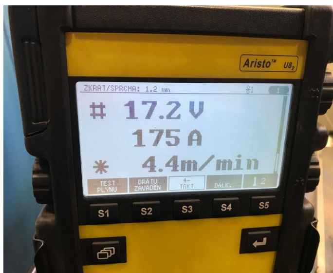
Obr. 31 a 32 Zdroj pro svařování, podavač drátu a ovládací panel Aristo U8 2
