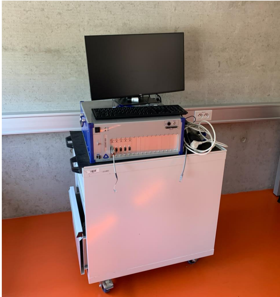
Obr. 12 Měřicí systém Dewetron DEWE 800 (zdroj: vlastní)
