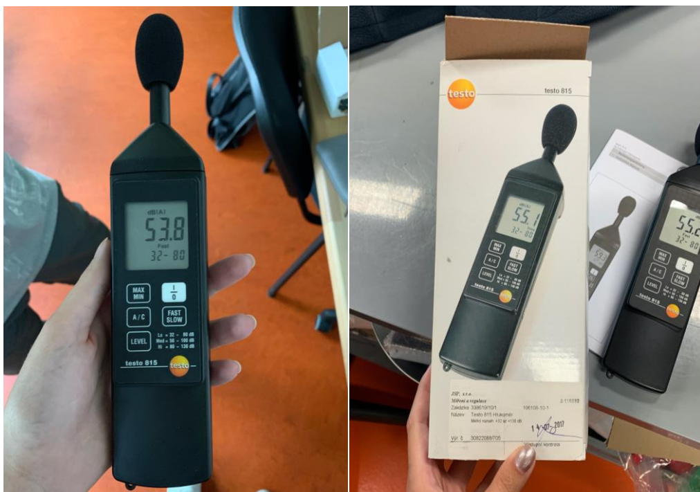
Obr. 16 Hlukoměr Testo 815 (vlevo), číselná hodnota úrovně hluku v místnosti (vpravo) (zdroj: vlastní)
