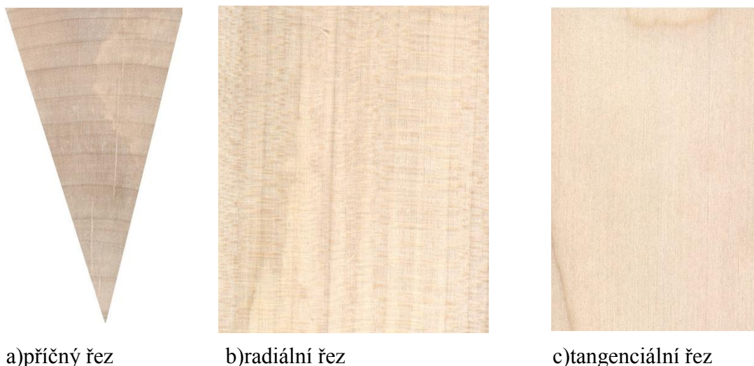
Obr. 3: Makroskopická stavba javoru, (Vavrčík, Lexikon dřev, 2002)
