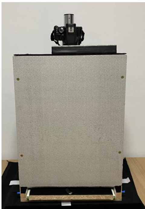
Obr. 45 Box s nasazeným izolačním krytem
