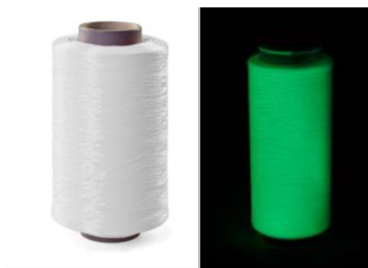
Obr. 12 Fotoluminiscenční vlákno MULTITEX [29]
