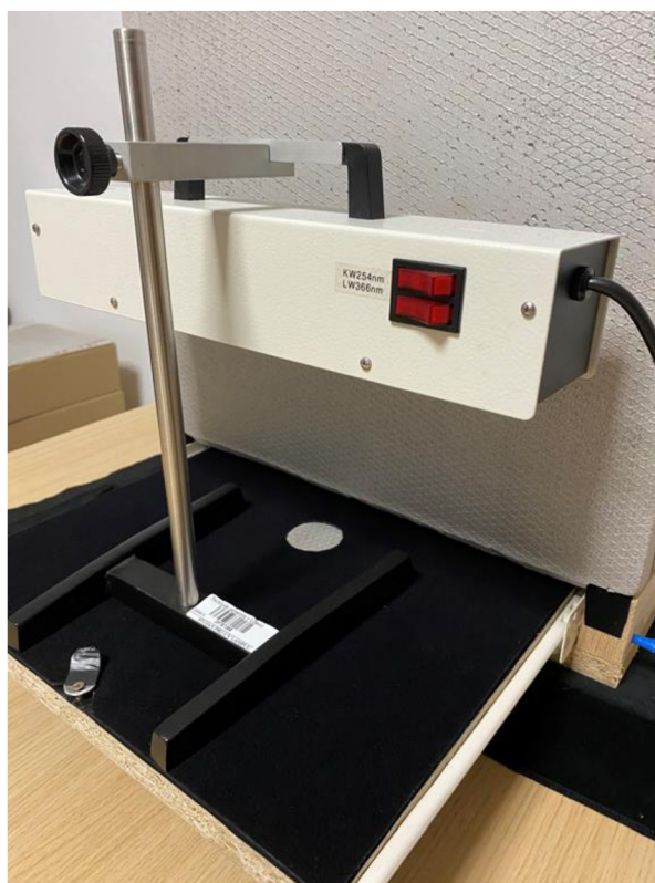
Obr. 52 Instalovaná UV lampa
