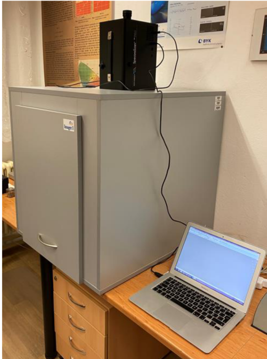
Obr. 24 Sestava zařízení pro měření luminiscence
