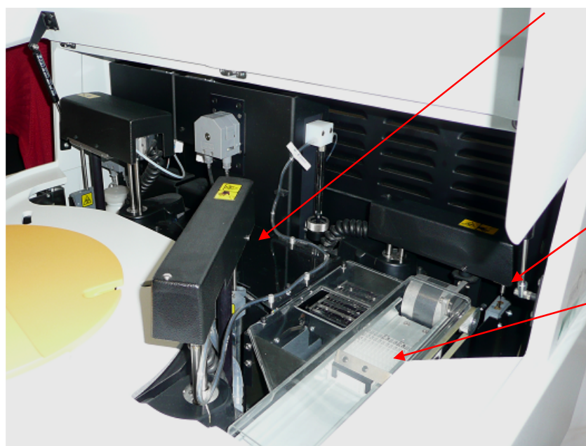
Obr. č. 13 Fotometrický analyzátor Aquakem 250
