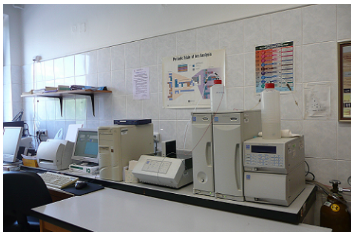
Obr. č. 16 Ionový chromatograf DX 320
