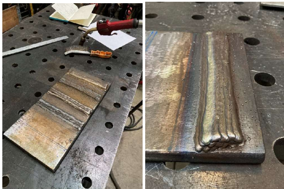
Obrázek 16 - Proces navařování vzorků (Vlastní zdroj [14])
