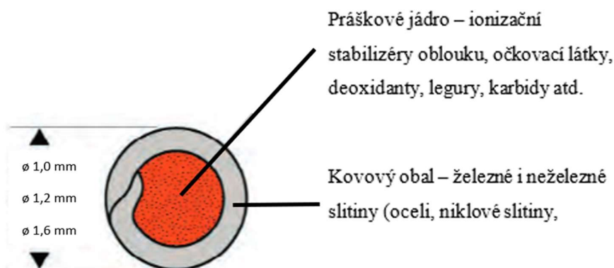
Obrázek 11 - Koncept trubičkového navařovacího drátu (Zdroj [22])
