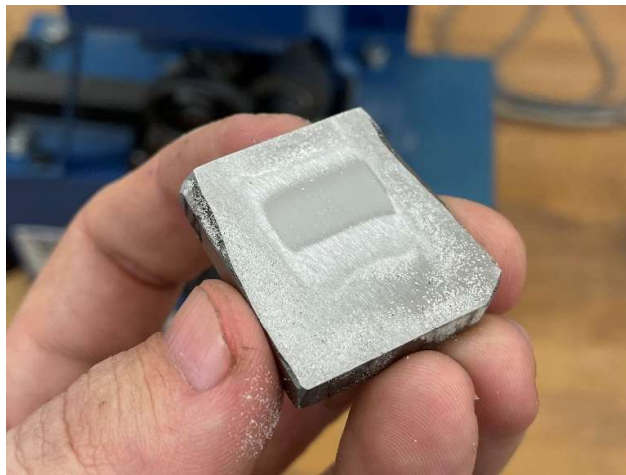
Obrázek 25 - Zkušební těleso po cyklu zkoušky opotřebení (Vlastní zdroj [14])
