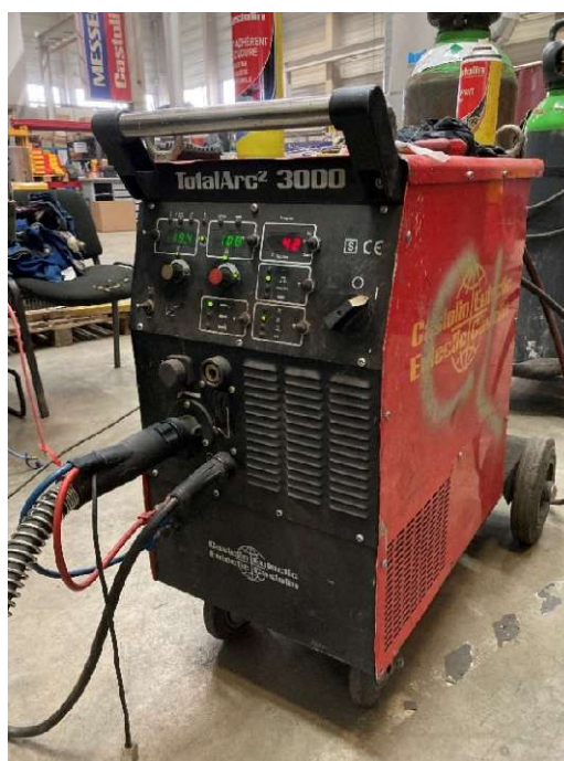
Obrázek 15 - Svařovací systém Castolin TotalArc 2 3000 (Vlastní zdroj [14])
