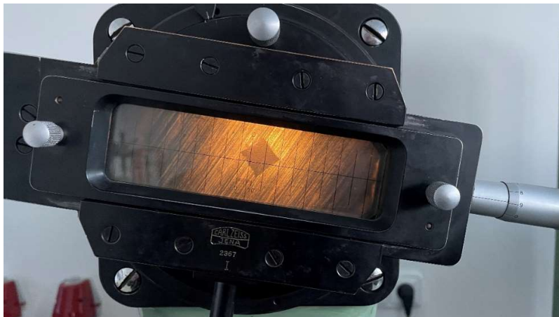
Obrázek 22 - Odečítací zařízení optického tvrdoměru (Vlastní zdroj [14])
