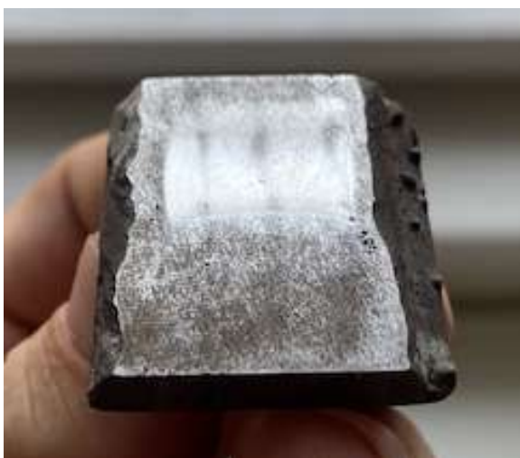
Obrázek 28 - Koroze na povrchu vzorku (Vlastní zdroj [14])
