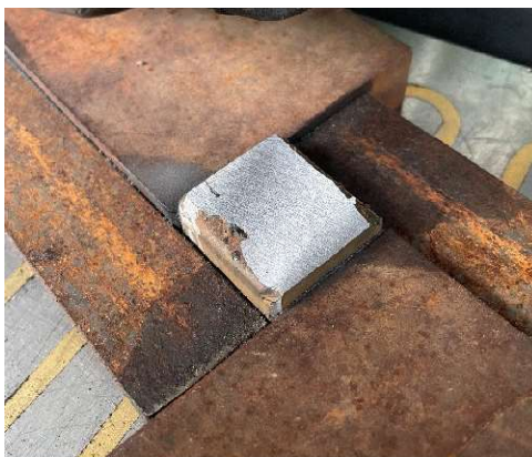
Obrázek 18 - Zkušební těleso v procesu přípravy – broušení (Vlastní zdroj [14])
