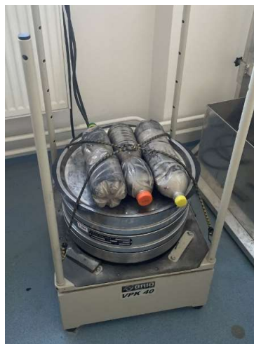
Obrázek 19 - Analytický prosévací přístroj VPK – 40 (Vlastní zdroj [14])
