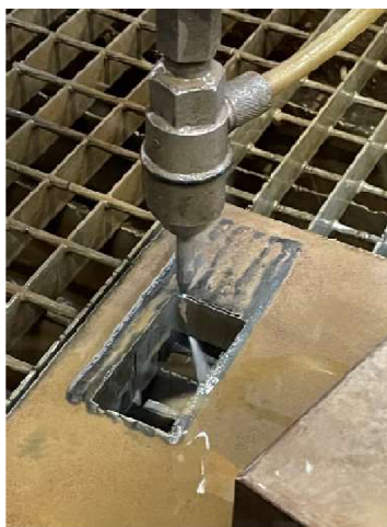
Obrázek 17 - Řezání zk. těles vysokotlakým vodním paprskem (Vlastní zdroj [14])
