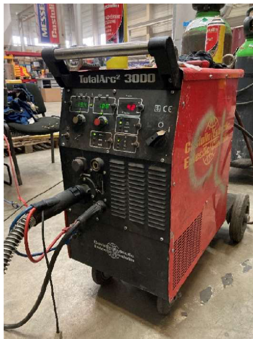
Obrázek 15 - Svařovací systém Castolin TotalArc 2 3000 (Vlastní zdroj [14])
