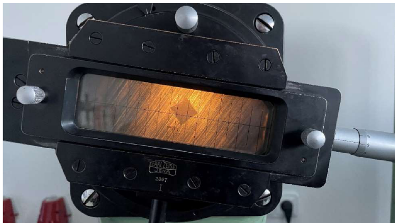
Obrázek 22 - Odečítací zařízení optického tvrdoměru (Vlastní zdroj [14])
