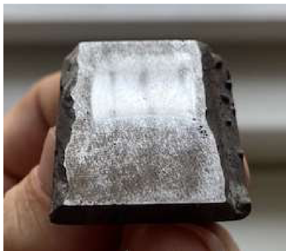
Obrázek 28 - Korozie na povrchu vzorku (Vlastní zdroj [14])
