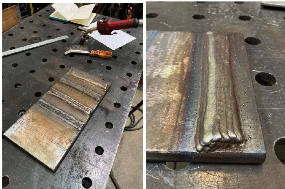
Obrázek 16 - Proces navařování vzorků (Vlastní zdroj [14])
