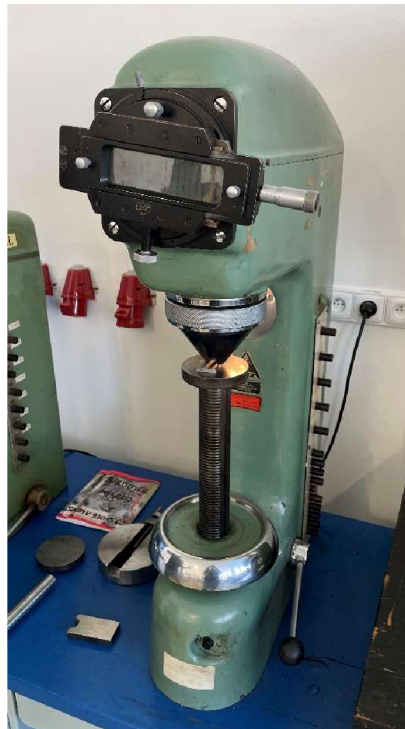
Obrázek 21 - Optický tvrdoměr (Vlastní zdroj [14])
