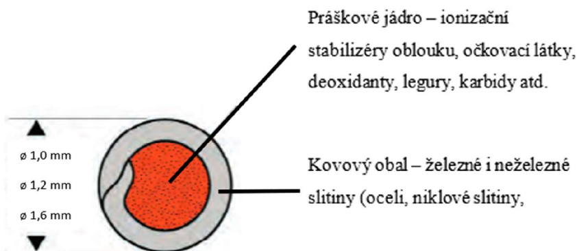
Obrázek 11 - Koncept trubičkového navařovacího drátu (Zdroj [22])
