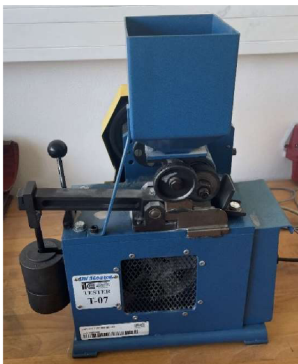
Obrázek 23 - Zkoušecí stroj abrazivního opotřebení ITE Tester T-07 (Vlastní zdroj [14])
