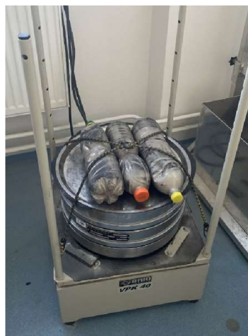
Obrázek 19 - Analytický prosévací přístroj VPK – 40 (Vlastní zdroj [14])
