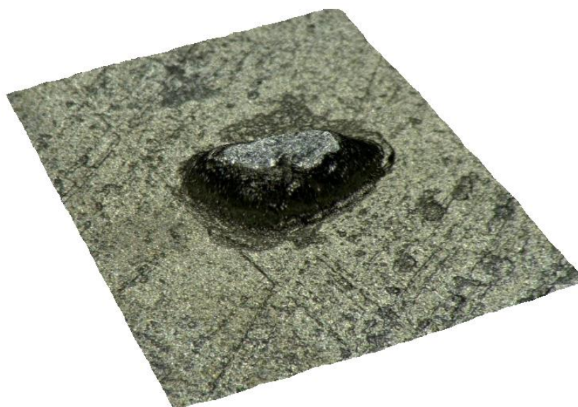
Obr. 4.2 Natavená tříška zobrazená ve 3D.
