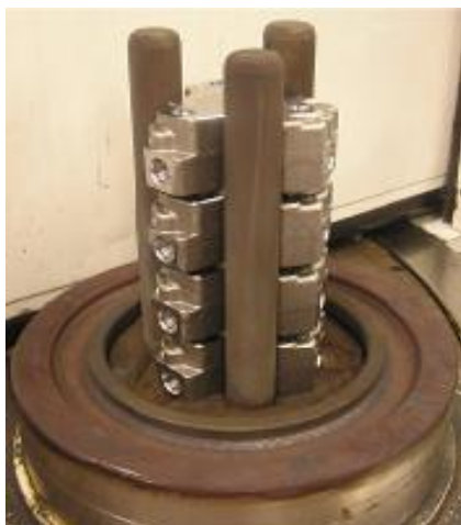
Obr. 2.3 Přípravek pro termické odjehlování naplněný obrobky [2].
