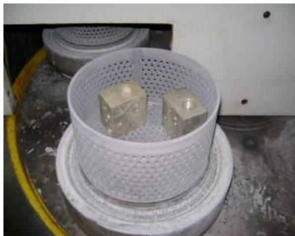
Obr. 2.4 Koš pro termické odjehlování [3].
