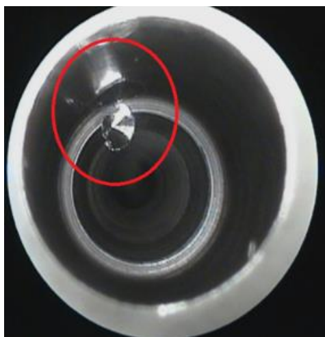
Obr. 5.20 Tvar přichycené třísky v místě B – tříska tvaru pokličky.
