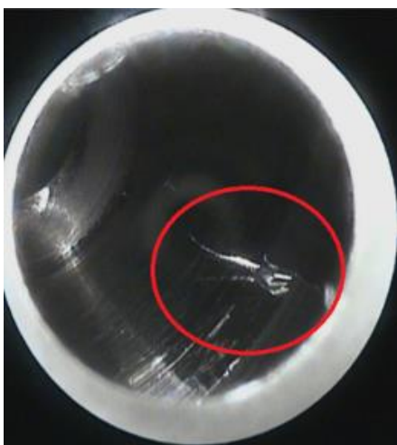
Obr. 5.22 Tvar jehlovité třísky v zafrézování mazacího kanálku.
