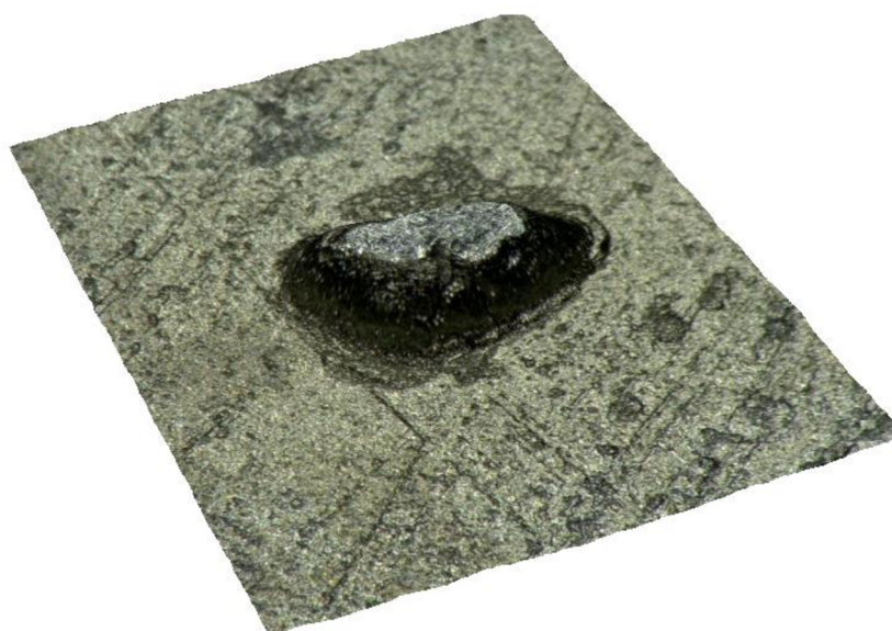
Obr. 4.2 Natavená tříška zobrazená ve 3D.
