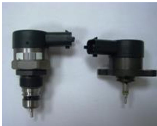
Obr. 1.4 Vysokotlaký ventil DRV2 a DRV1 [2].
