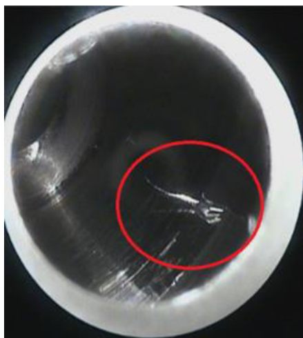
Obr. 5.22 Tvar jehlovité třísky v zafrézování mazacího kanálku.
