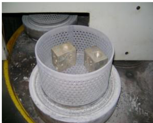
Obr. 2.4 Koš pro termické odjehlování [3].
