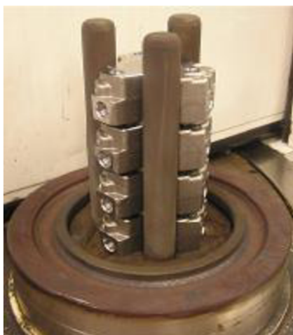
Obr. 2.3 Přípravek pro termické odjehlování naplněný obrobky [2].
