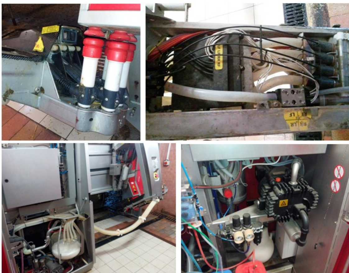
Obr. 20 Součásti technologického celku pro získávání mléka Lely Astronaut A4
