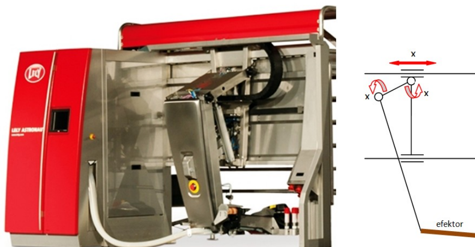
Obr. 16 Obrázek provedení šasi, pohybových vazeb ramene a umístění efektoru - Lely
