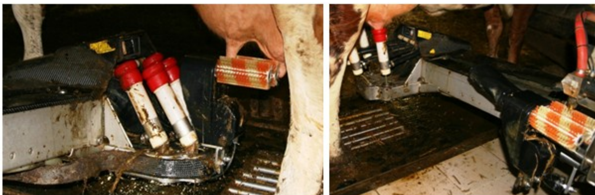
Obr. 28 Pracovní a klidová poloha čistících kartáčků na otočném rameni
