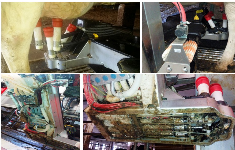
Obr. 19 Detail provedení efektoru Lely Astronaut A4
