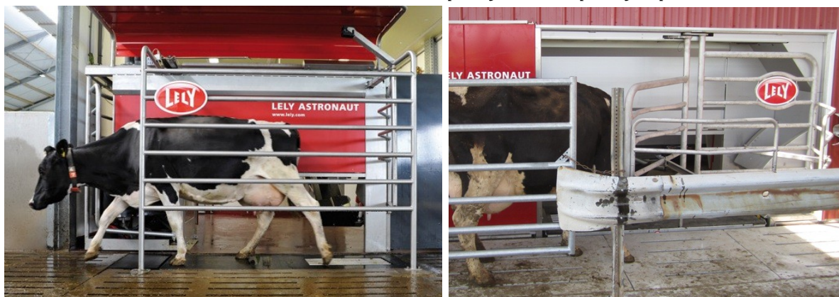
Obr. 23 Příklad konstrukce boxů s přímým a úhlopříčným průchodem
