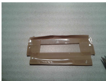
Obr. č. 9: ITO sklo oblepené páskou [vlastní]
