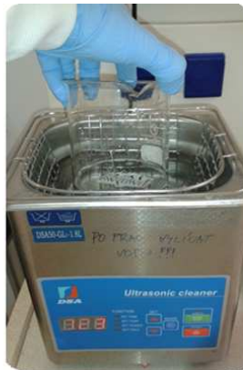
Čištění substrátů UV lázeň
