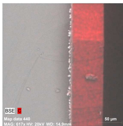
Obr. č. 34: Snímek vzorku 1EDS – zobrazení pomocí zpětně odražených elektronů, (červeně vyznačená oblast obsahující uhlík) [vlastní]
