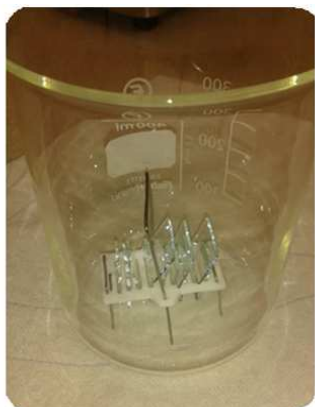
Čištění substrátů NaOH
