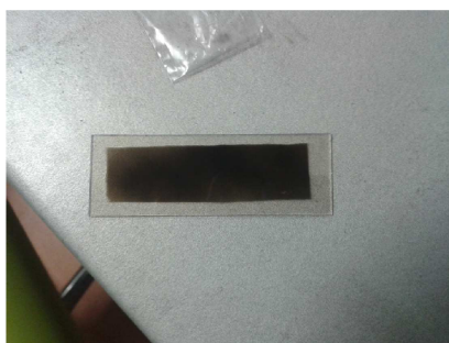
Obr. č. 13: Protielektroda s vrstvou uhlíku [vlastní]
