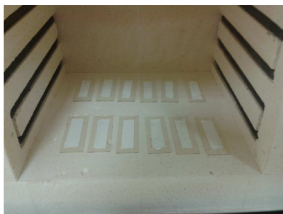
Obr. č. 11: ITO skla v peci před vypálením [vlastní]
