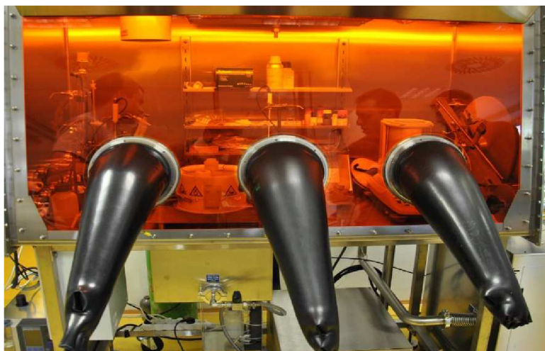
Obr. č. 41: Glove box s oranžovým osvětlením uvnitř (FEKT VUT) [vlastní]
