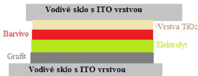
Obr. č. 2: Schéma struktury solárního článku [vlastní]
