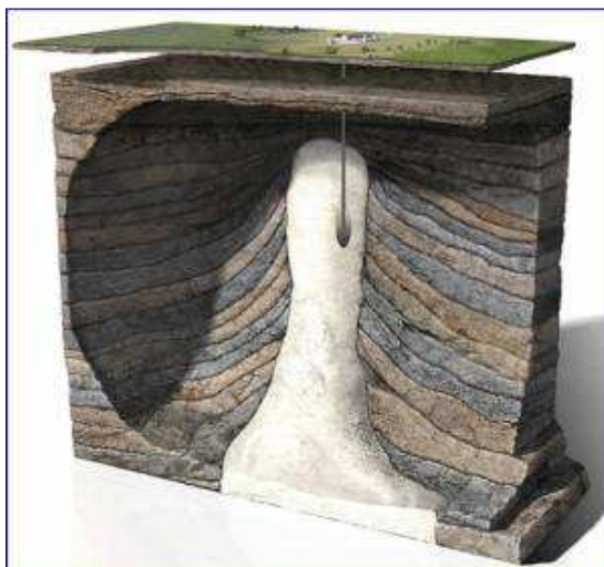
Obrázek 8.1 - Příklad zásobníku v solném dómě [10]
