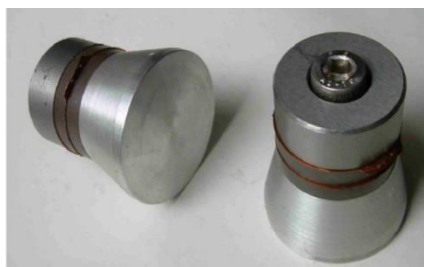
Obr. 11 – Ultrazvuková půlvlnná rezonanční piezoelektrická jednotka s nízkou amplitudou (Jahno et al., 2010).
