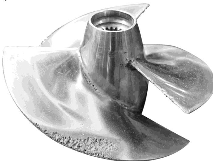
Obr. 1– Kavitační eroze na lopatkách lodního šroubu (Asnaghi, 2015).
