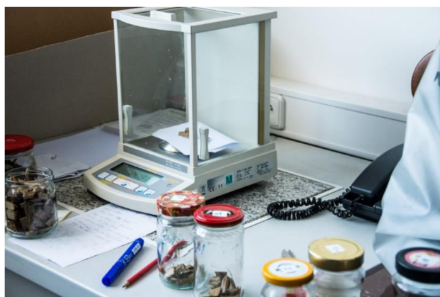
Obr. 27 – Fotografie analytických vah použitých v experimentu.
