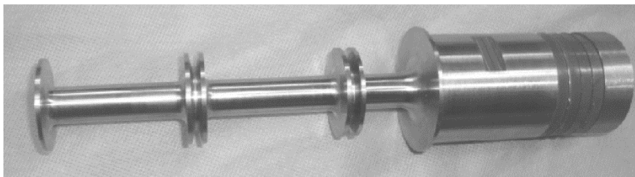
Obr. 20 – Ultrazvukový rezonanční emitor pohonu s vyvinutým radiačním povrchem (Griško et al., 2011)
