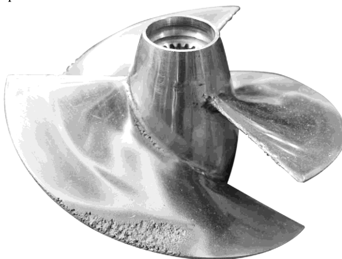
Obr. 1– Kavitační eroze na lopatkách lodního šroubu (Asnaghi, 2015).
