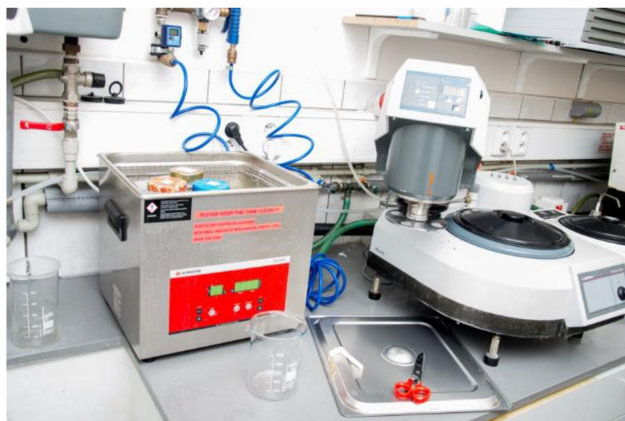
Obr. 26 – Fotografie ultrasonické čističky použité v experimentu.
