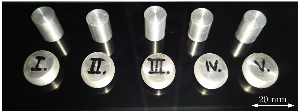
Obr. F.1: Tvar piatich vzoriek pred a po ubíjacej skúšky, zliatina EN AW-6061 T6511.
