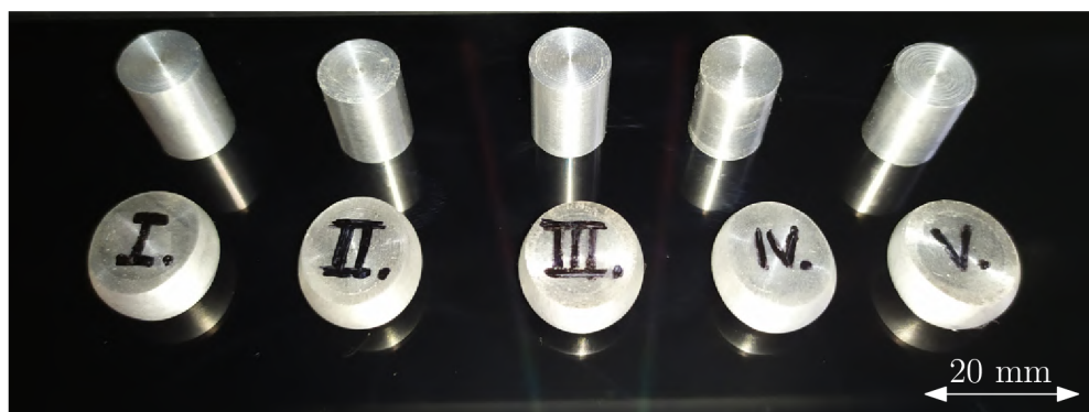
Obr. F.1: Tvar piatich vzoriek pred a po ubíjacej skúšky, zliatina EN AW-6061 T6511.
